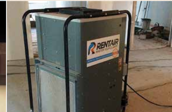
Mobiele (bouw)droging Déshumidificateurs mobiles (de chantier)
